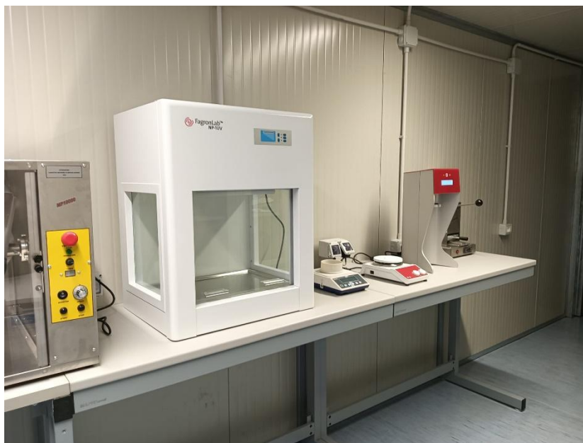
Attrezzature galeniche: miscelatore di polveri, cappa a flusso laminare, bilancia, agitatore magnetico, mixer, blisteratrice.
